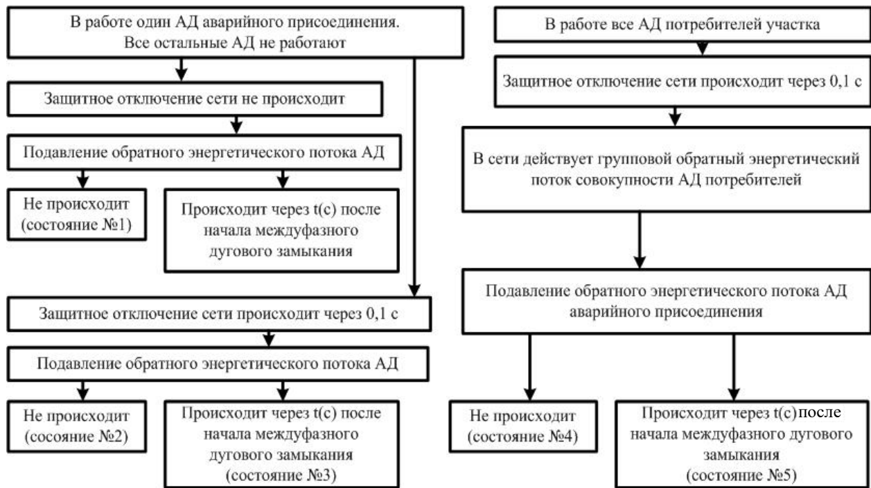
Рис. 2. Состояния электротехнического комплекса, принятые для исследования
