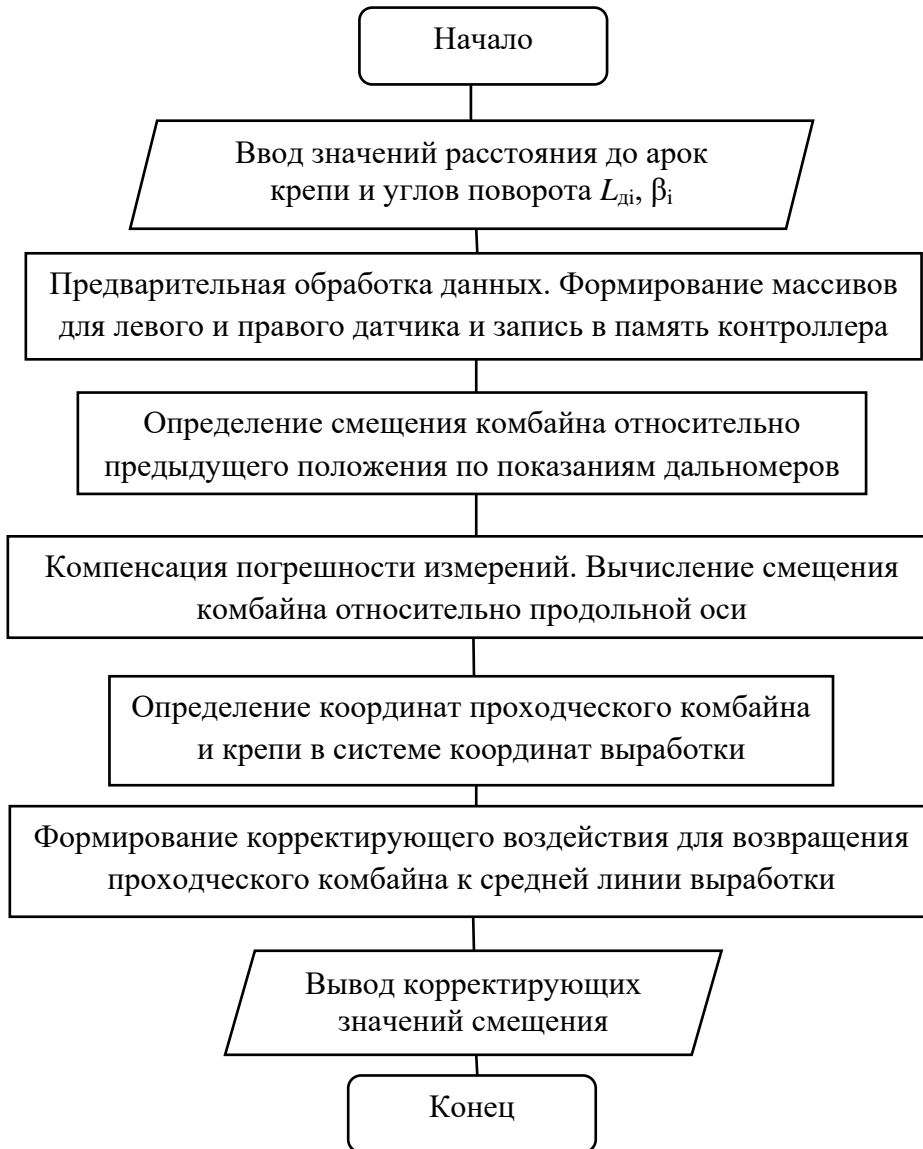
Рис. 2. Алгоритм реализации способа определения местоположения проходческого комбайна по данным датчиков
