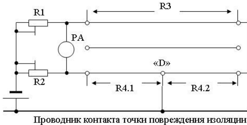
Рис. 3. Схема, иллюстрирующая концепцию петлевого метода определения места (точка «D») повреждения изоляции фазы кабеля
