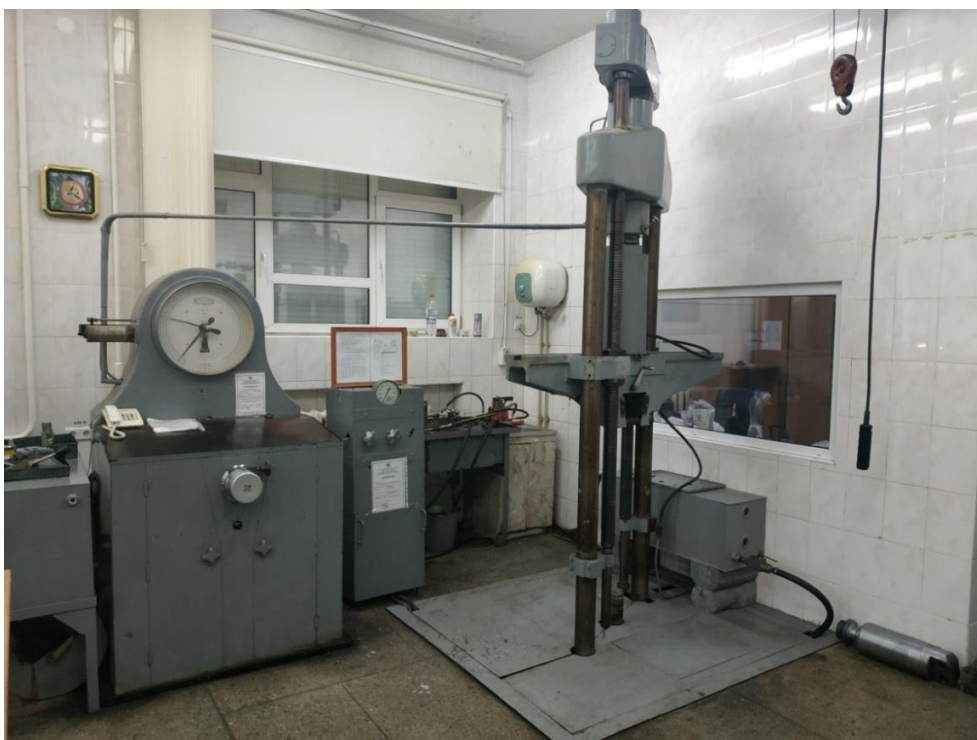
Рис. 3. Общий вид установки для испытания предохранительных клапанов
