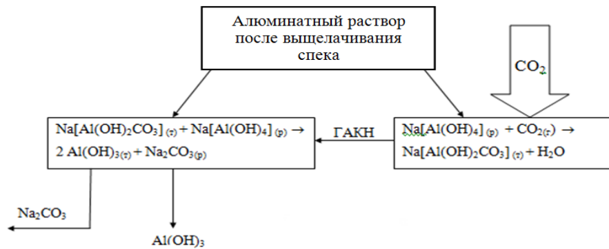
Рис. 4. Упрощенная схема получения \text{Al}(\text{OH})_3 из растворов алюмината натрия
