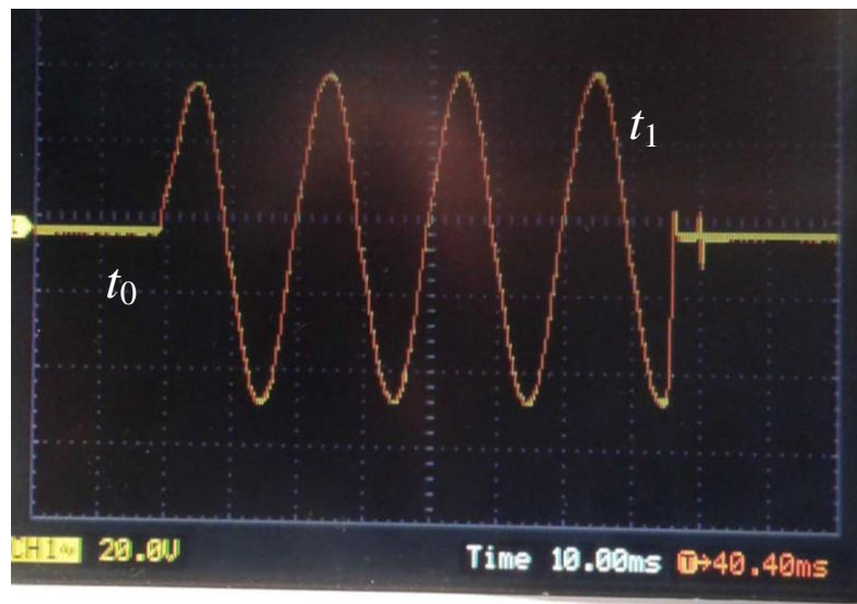
Рис. 6. Осциллограмма тока в цепи короткого замыкания при исследовании схемы стенда по рис. 5: уставка БЗУ-ТП – 501 А; U_d=4,5 В; I_m=1018 А, срабатывание автоматического выключателя А3792 по команде блока БЗУ-ТП, сопровождаемое «спеканием» силовых контактов вакуумного контактора SPVC1-630
