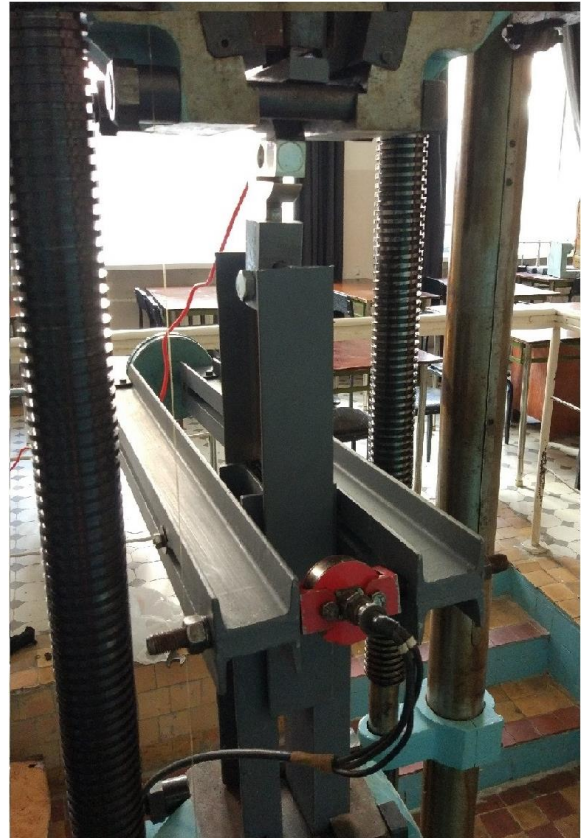
а б Рис. 2. Стенд для исследования тормозных устройств и определения коэффициента трения тормозных колодок с монорельсом:
