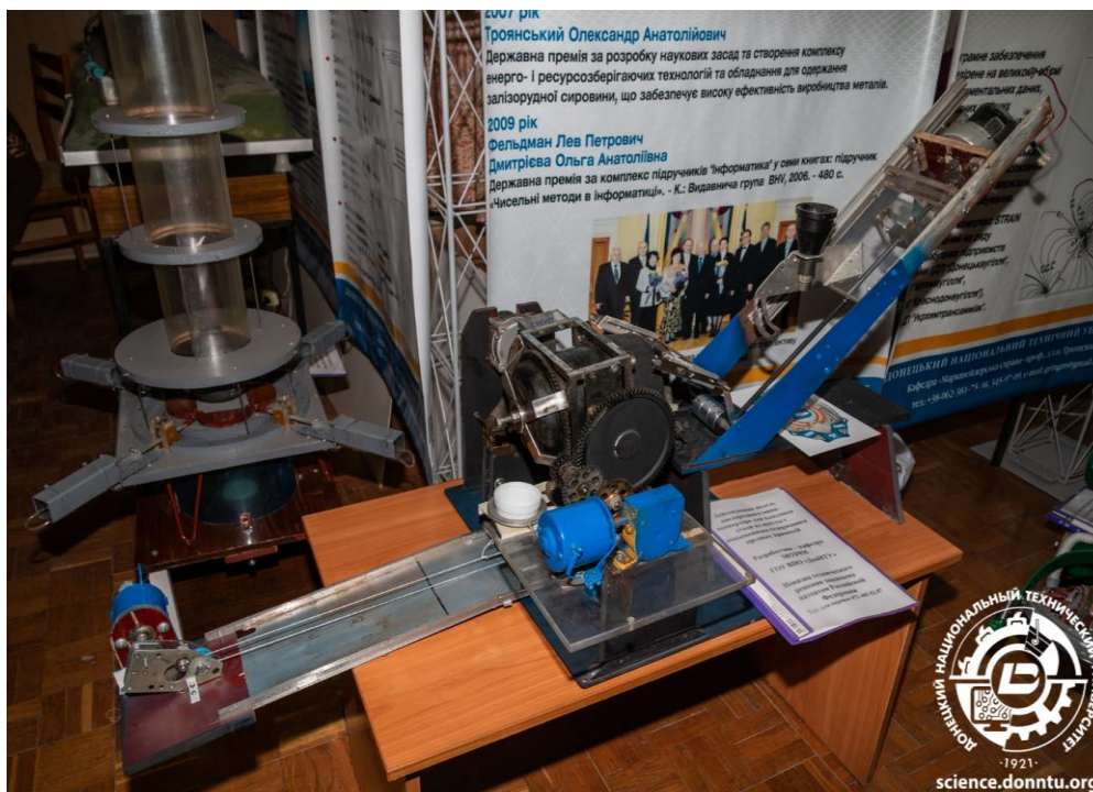
Рис. 4. Экспозиция физических моделей факультета инженерной механики и машиностроения на выставке научно-технических разработок молодых ученых Донбасса, 2018 г.: передний план – конвертер с вращающимся корпусом для переработки некачественной шихты и металлосодержащих отходов с высоким содержанием вредных примесей; задний план – выгрузочное устройство шахтной известково-обжигательной печи
