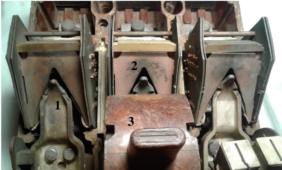
Рис. 1. Общий вид силовой трехполюсной контактной группы автоматического выключателя А3792:
