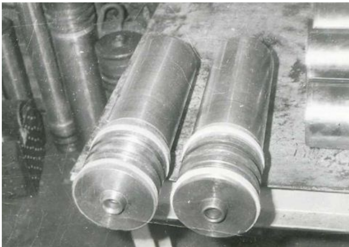
Рис. 6. Плунжеры с грязезащитными элементами из пенополиуретана в цехе № 1 Рутченковского завода «Гормаш»
