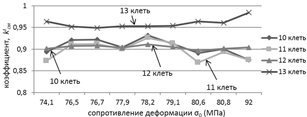
Рис. 2. Изменение коэффициентов влияния СМ  $k'_{см}$  в зависимости от сопротивления деформации  $\sigma_0$  для клеток №10-13 НШСГП 2000
